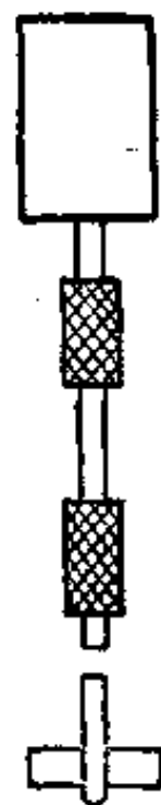
图 13-3 拌搅棒与马达的连接
